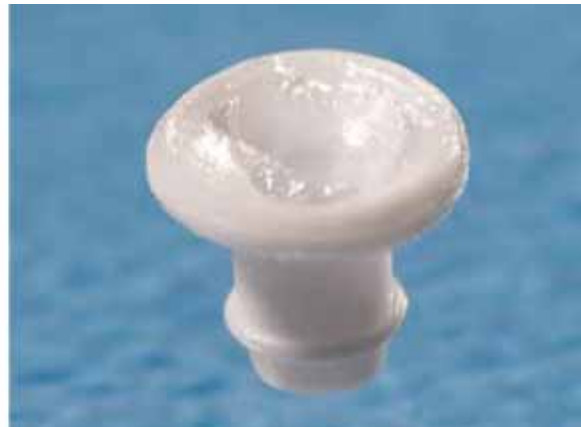
フィルムが損傷している状態
