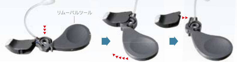
マイクチューブの外し方 (図は左耳用です)
